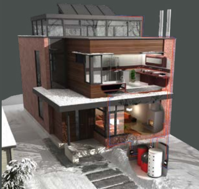
Schnittmodell eines in ein Heizsystem integrierten wassergeführten Kamineinsatzes
